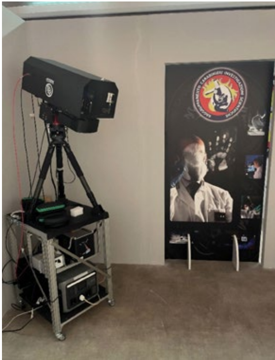
Sensore "RAMAN" sviluppato da ENEA che consente di esaltare tracce molto piccole e a grande distanza (fino a 7 metri).
