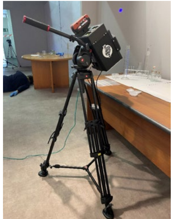
Strumento "IR", un sensore ottico non invasivo e no-contact che supporta la qualificazione delle tracce tramite spettroscopia.
