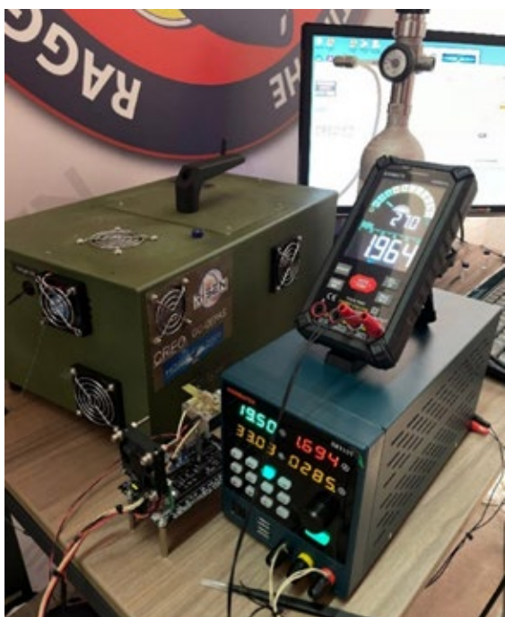
Sensore "GC-QEPAS" sviluppato da CREO, è un sensore portatile per il riconoscimento di tracce chimiche in fase di vapore, basato sulla gas-cromatografia.
